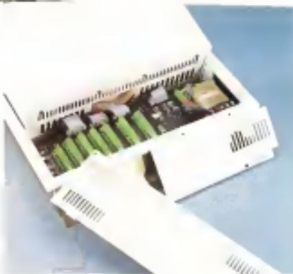
Tutte le due mascherine di protezione si innalzano alla pressione senza intervento di nessuna vite e sui vanni collegati elettricamente i vari sensori si parlano. In senso ed il cavo TV per la televisione. Da notare una piccola lenza di Fresnel che permette alla televisione calata a raggi infrarossi di rilevare la presenza di persone.
